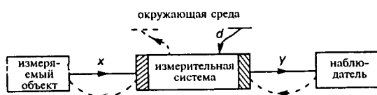
Рис. 2.49. Взаимодействие между измерительной системой, измеряемым объектом, наблюдателем и их окружением ( x - входной сигнал, y - выходной сигнал, d - помехи).
