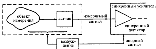
Рис. 3.45. Применение синхронного детектирования в измерениях с целью достижения минимально возможного порога чувствительности.
