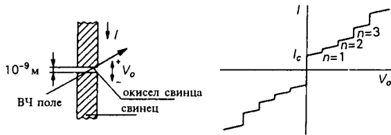
Рис. 2.3. Зависимость тока через джозефсоновский контакт от напряжения на нем, используемая в настоящее время в эталонах разности электрических потенциалов (напряжения).
